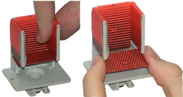
bestimmtes Reflexionsverhalten auf. Dieses schätzt man ab und überträgt es gleichsinnig durch Verstellen der Roll- und Faltschleuse auf die entsprechenden Begrenzungsflächen des Fühlerraumes. Danach wird das Fühleroberteil wieder montiert.
